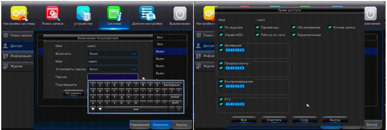
После проведения настроек доступа на быстрой панели появится значек в виде замка, кликнув по нему, появится панель доступа. Для входа введите логин и пароль.
