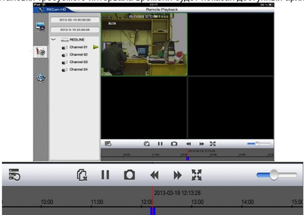
Используя данный элемент управления в панели инструментов, можно перематывать запись, делать скриншот экрана, выводить изображение во весь экран и увеличивать/уменьшать громкость звука.
