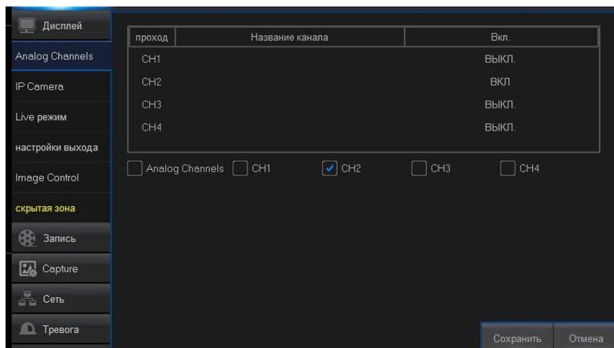
Для отключения камеры необходимо снять галочку с поля расположенного рядом с номером канала и нажать сохранить.
