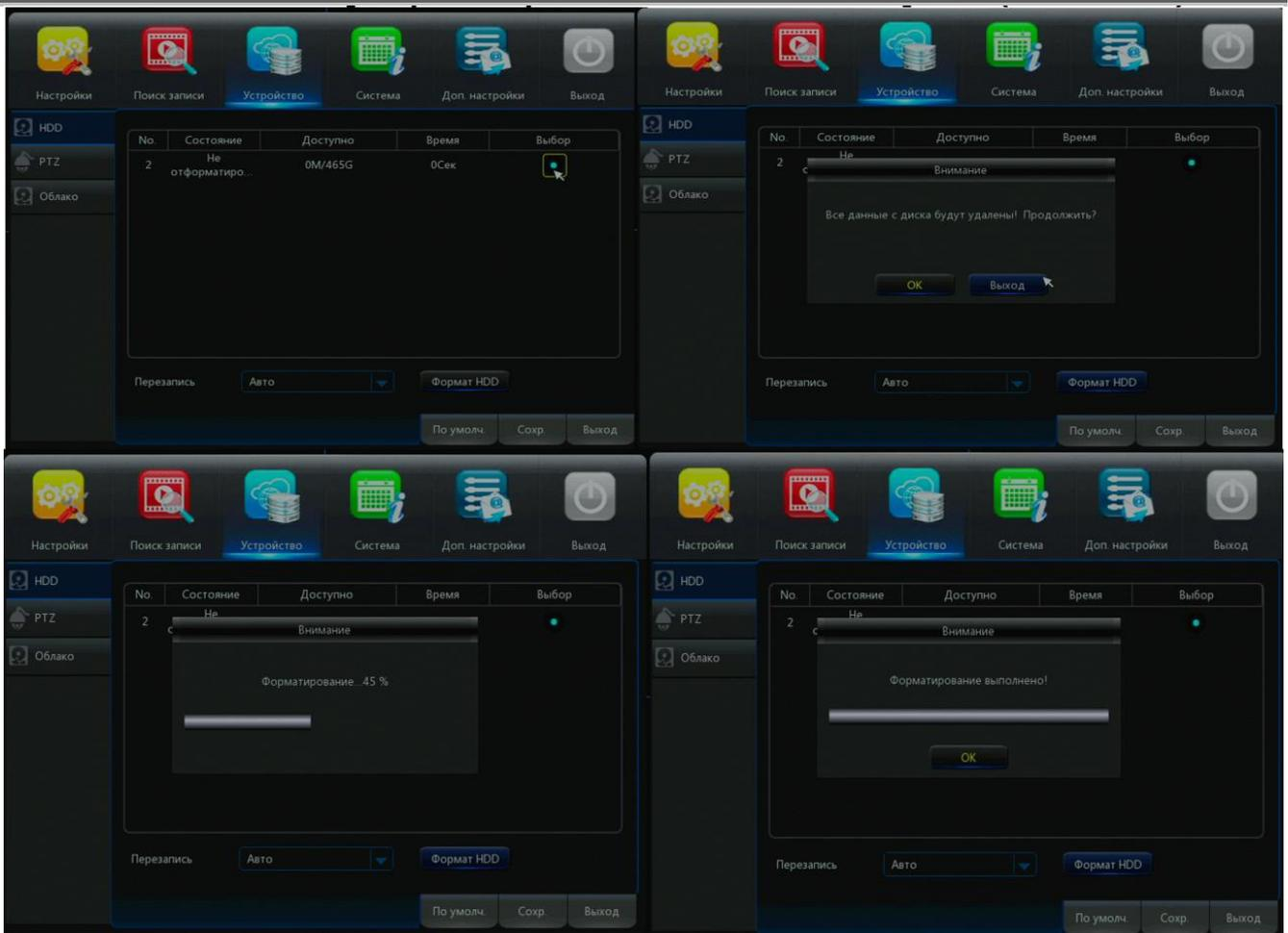
Если HDD используется впервые, то необходимо произвести форматирование HDD для возможности записывать на этот диск. Нажмите кнопку [Форматирование] для начала форматирования. В окне нажмите [OK] для подтверждения форматирования, или нажмите [Выход] для выхода. Перед форматированием система сообщит [Все данные с диска будут удалены продолжить?], далее нажмите кнопку [OK], система начнет [Форматирование...] по окончании система сообщит [Форматирование выполнено].
