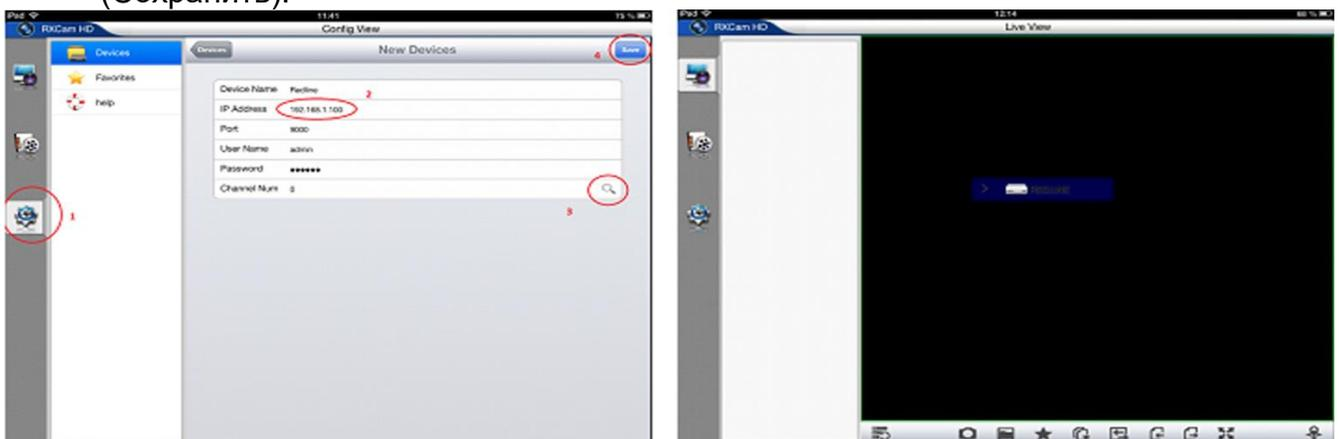
Для просмотра отображения с камер перетащите устройство на правую часть экрана. Live View (Живое отображение)
