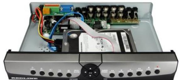
Поместите жесткий диск на крепление и выровняйте положение винтового отверстия жесткого диска относительно крепления. Закрепите жесткий диск на креплении с помощью винтов из комплекта поставки, закройте крышку видеорегистратора и закрутите фиксирующие винты крышки.
