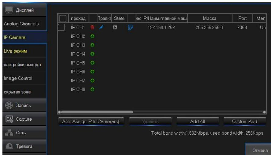
Auto Assign IP to Cameras – Автоматическое присвоение IP адресов камерам.
