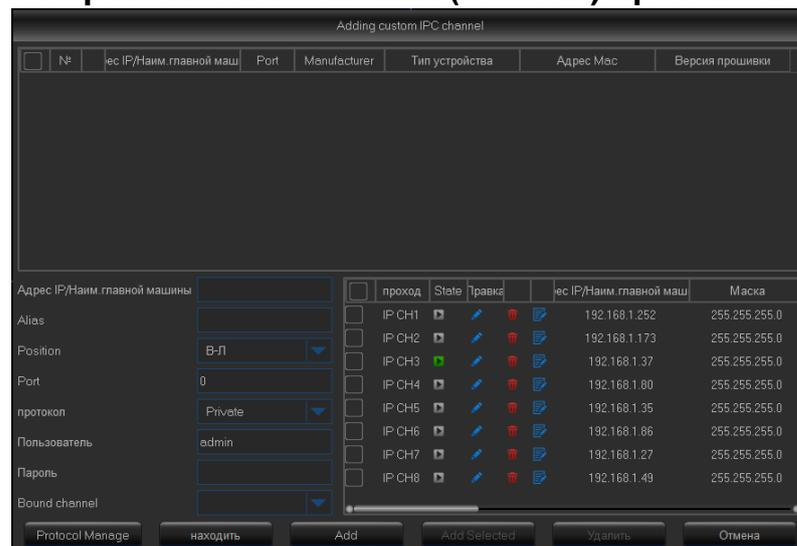
Для добавления камеры с использованием протокола не предусмотренного по умолчанию необходимо произвести поиск камер, затем нажать Protocol Manage (Редактирование протокола).
