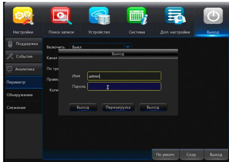
Для санкционированного и правильного выключения видеорегистратора или его перезагрузки, необходимо зайти в [Основное меню] далее [Выход]. Необходимо выбрать действие выключение или перезагрузка. Система попросит ввести логин и пароль для разрешения перезагрузки или выключения. После введенного логина и пароля система остановит и сохранит последние записи и разрешит безопасно выключить питание.
