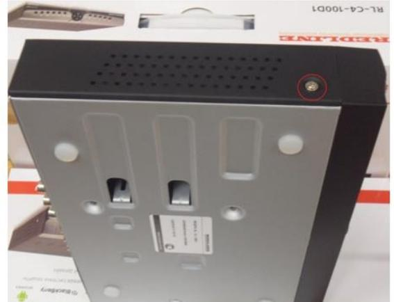
Сдвиньте крышку в направлении задней панели и снимите ее
